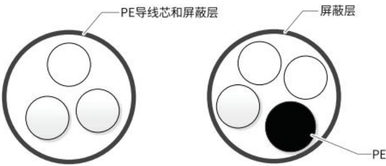
图 4-3 推荐的动力线缆类型
