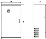
160 ~ 450KW变频器外形尺寸及安装尺寸示意图
