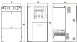
11 ~ 15KW型壳式箱外形尺寸及安装尺寸示意图
