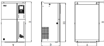
45~132kW变频器外形尺寸及安装尺寸示意图
