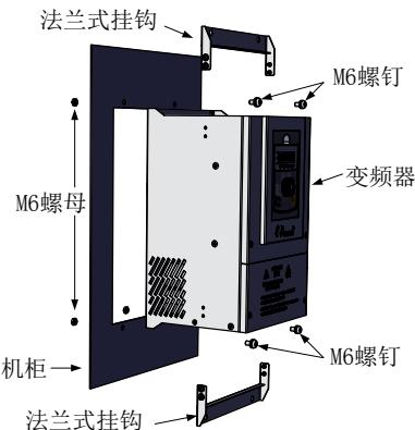
图3-4. CM530H变频器钣金结构穿墙式安装图
