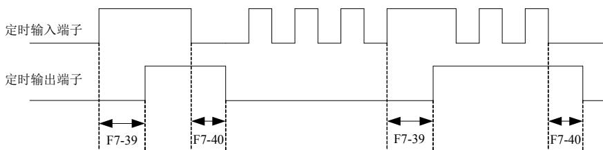
图 5-19. 定时器输入输出动作简图
