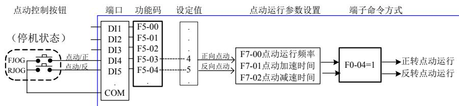
图4-16. DI方式点动参数设定示意图
