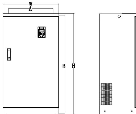
图 2-7. 7T 75KW 以上变频器外型尺寸及安装尺寸示意图
