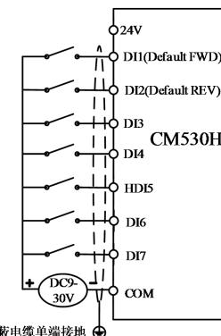
图3-11. 四种不同模式下数字输入端子接线图
