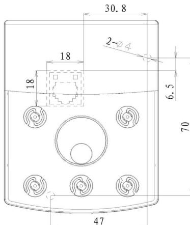
图2-8. 外引键盘不带托盘安装尺寸图
