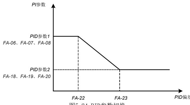
图5-24. PID参数切换
