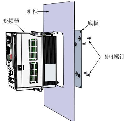
图3-3. CM530H变频器塑胶结构穿墙式安装图
