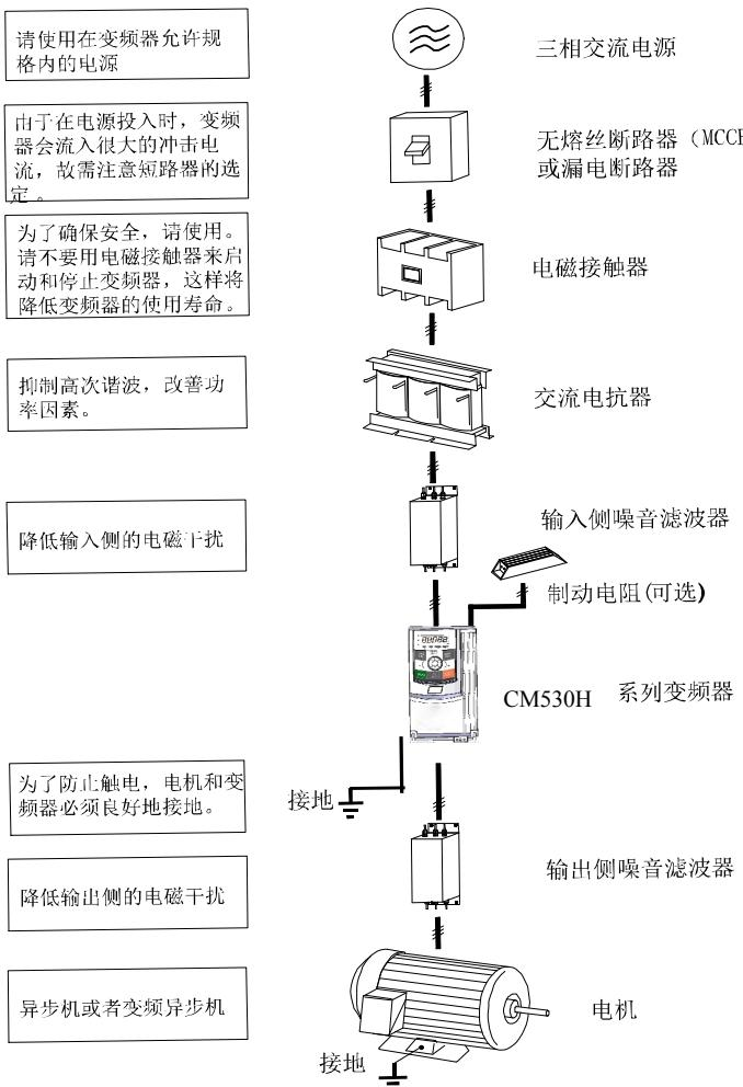
图 1 与外围机器的连接示例
