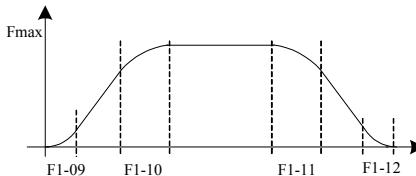
图 5-3. S 曲线加减速示意图
