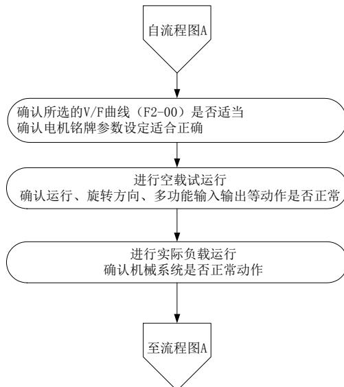
图 4-7. V/F 控制方式运行步骤
