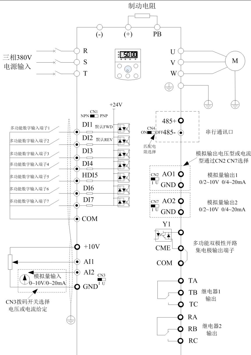
注意：此图适用于 CM530H-A4TR75GB ~ CM530H-B4T030GB 系列变频器 (CM530H 系列 30~93KW 制动单元部分属选配功能，CM530 系列 18~55KW 制动单元部分属选配功能，如有需求，订货时请说明)。
