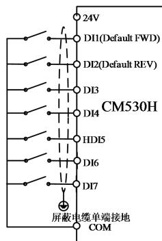
DI接线模式二：当DI拨码开关为NPN模式使用外部电源
