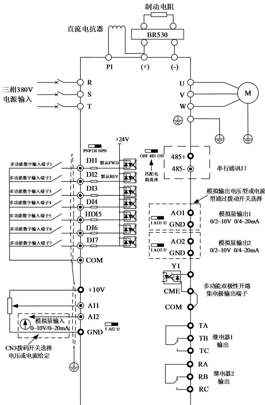
图 3-9. (4T/7T) 75kW 及以上三相变频器
