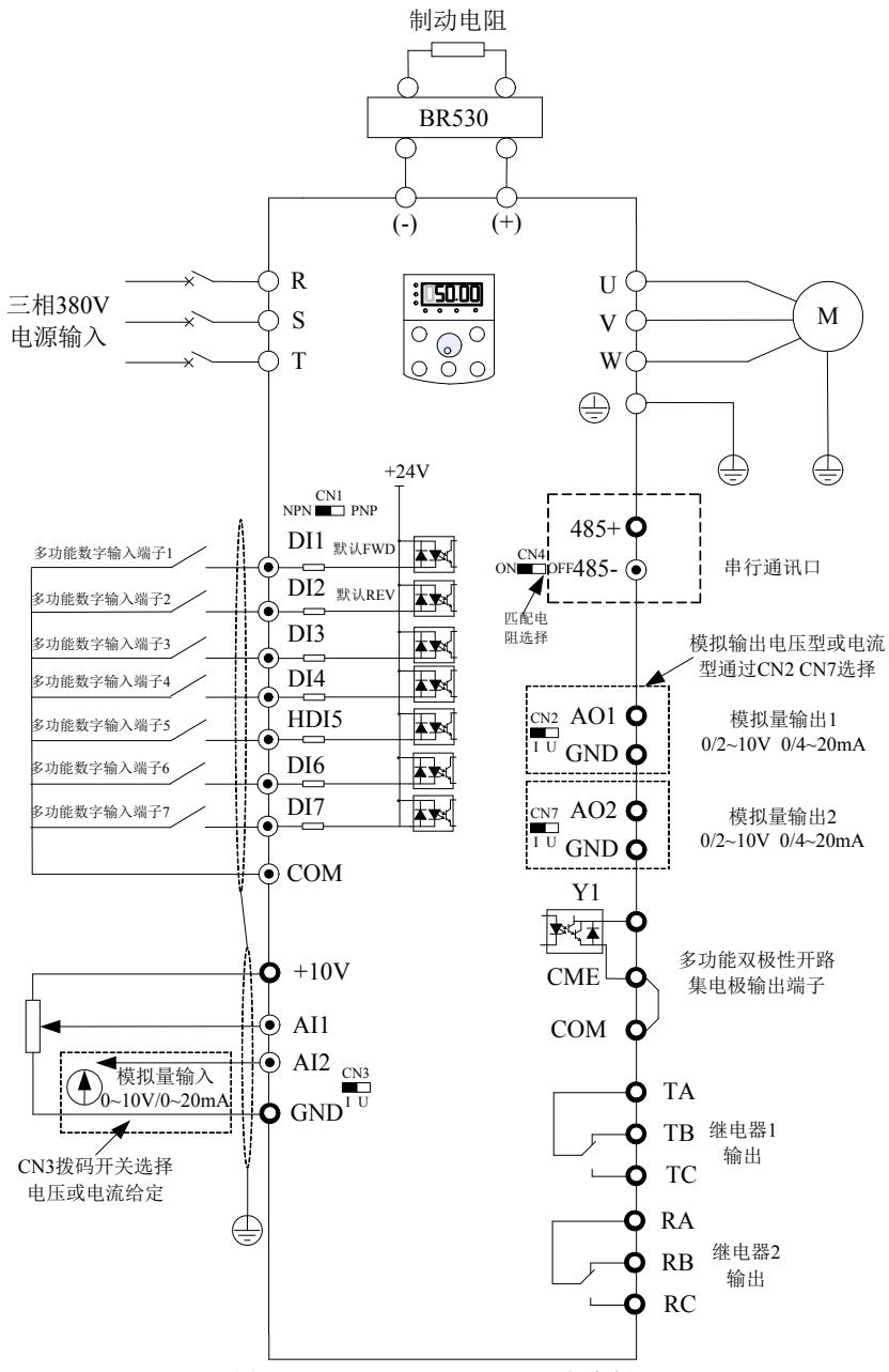
图 3-8. (4T/7T) 37kW ~ 55kW 三相变频器
