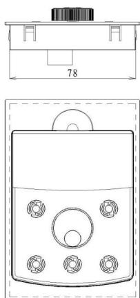
图2-7. 外引键盘带托盘安装尺寸图
